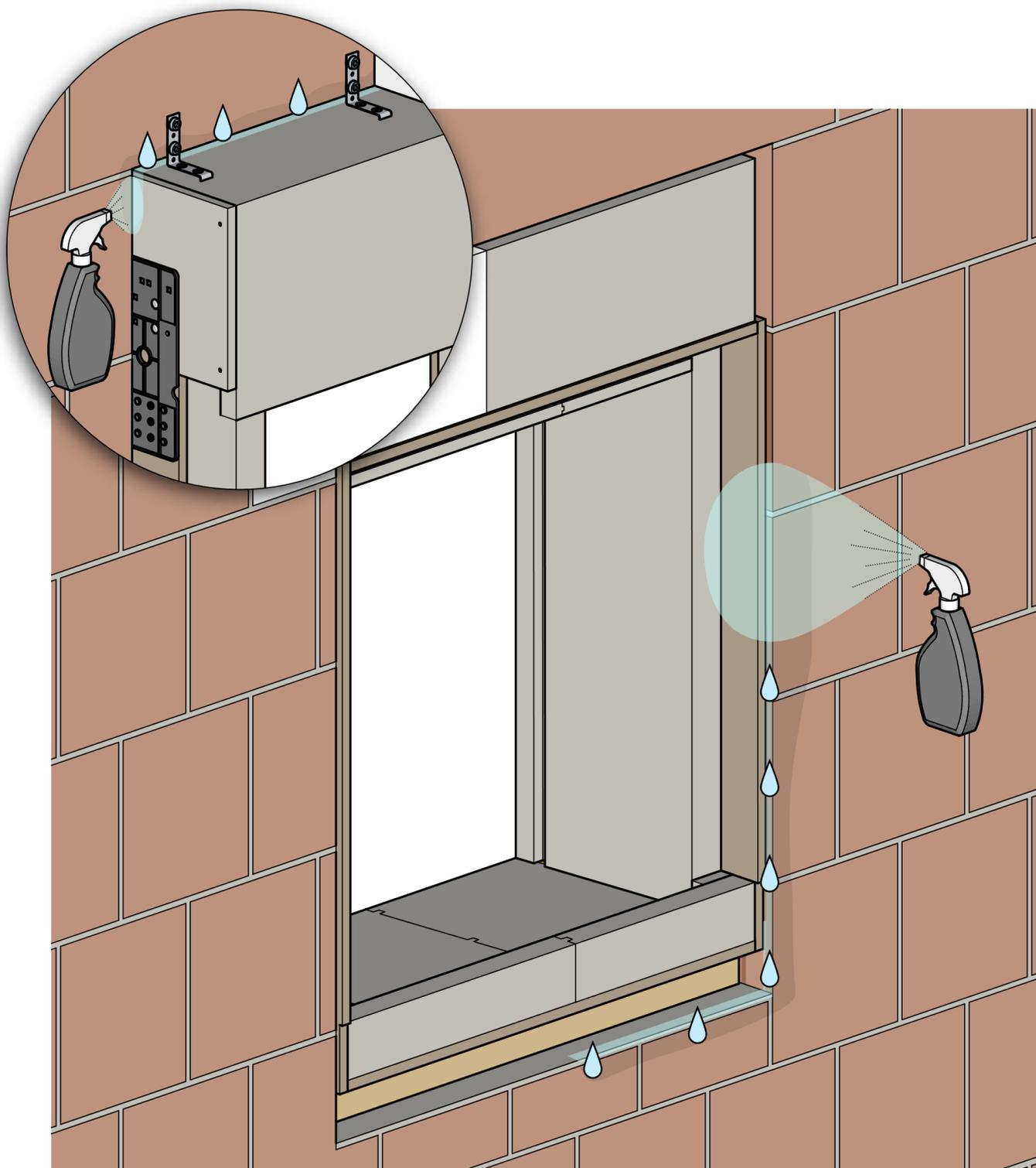
Prima di isolare il foro finestra, pulire ed inumidire le superfici interessate. L'acqua serve ad attivare la schiuma isolante, facendola espandere in modo ideale, così da ottenere continuità di materiale tra il Monoblocco e il foro finestra.
