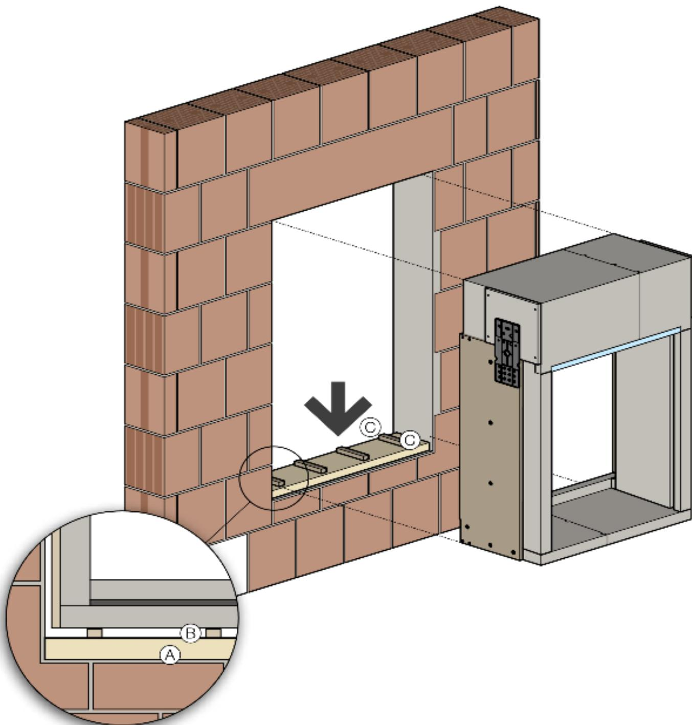
Se il foro finestra è più ampio del dovuto, appoggiare il sottobancale del Monoblocco sopra un supporto portante (A) e possibilmente isolante. Lasciare sempre una fuga (B) anche sul quarto lato, quello tra davanzale e sottobancale, in modo da garantire una sigillatura integrale. È altresì opportuno che sul filo esterno ed interno, davanti al materiale di appoggio, resti sufficiente spazio per l'isolamento con schiuma poliuretana (C).
