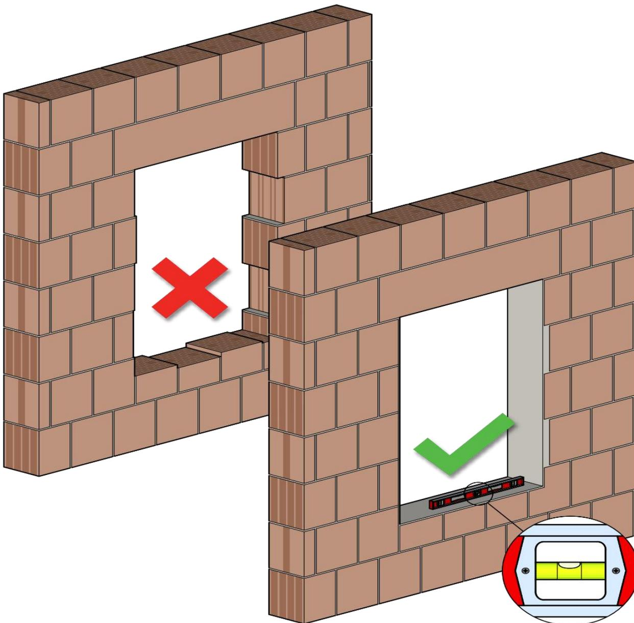
Per una corretta posa del Monoblocco è necessario livellare il davanzale per evitare irregolarità che possono compromettere la tenuta all'aria del foro finestra. La muratura deve garantire il fissaggio meccanico del traverso inferiore e delle spalle del serramento.
