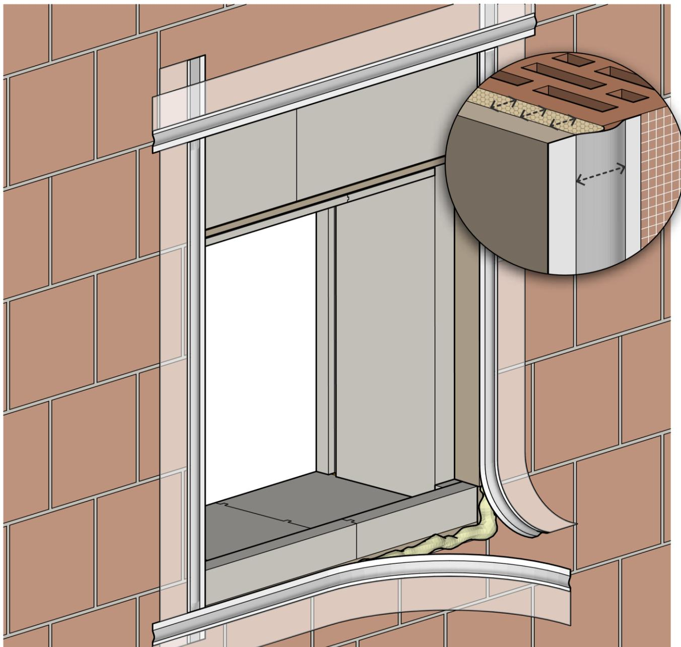
Applicare il nastro adesivo sia per l'interno che per l'esterno abitazione, facendo attenzione durante l'incollaggio che la membrana sia leggermente flessa centralmente, per assorbire gli assestamenti senza tendersi e lacerarsi. La membrana dovrà risultare quindi morbida e non tesa lungo tutto il perimetro di congiunzione tra la muratura e il monoblocco.
