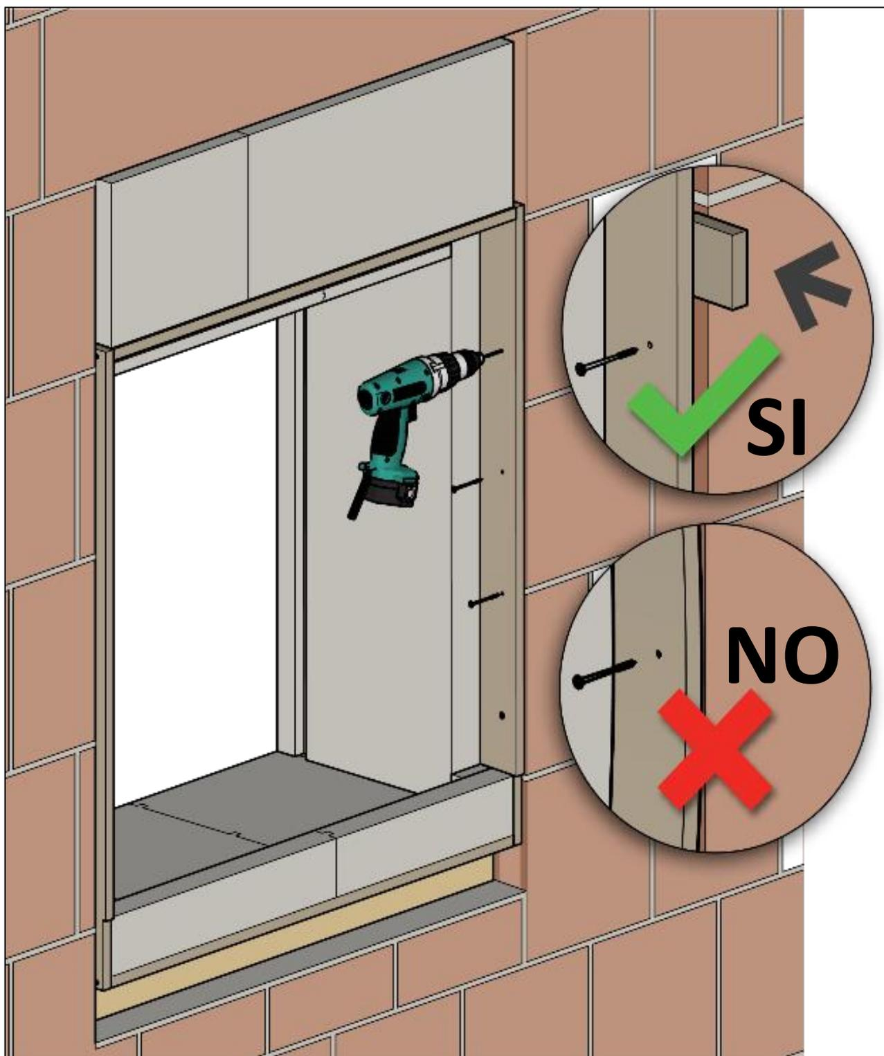
Ancorare il Monoblocco al foro finestra con il sistema più adatto alla tipologia muraria del fabbricato. Inserire gli spessori in corrispondenza dei punti di ancoraggio per evitare che il Monoblocco o Controtelaio perda il corretto allineamento e si fletta.
