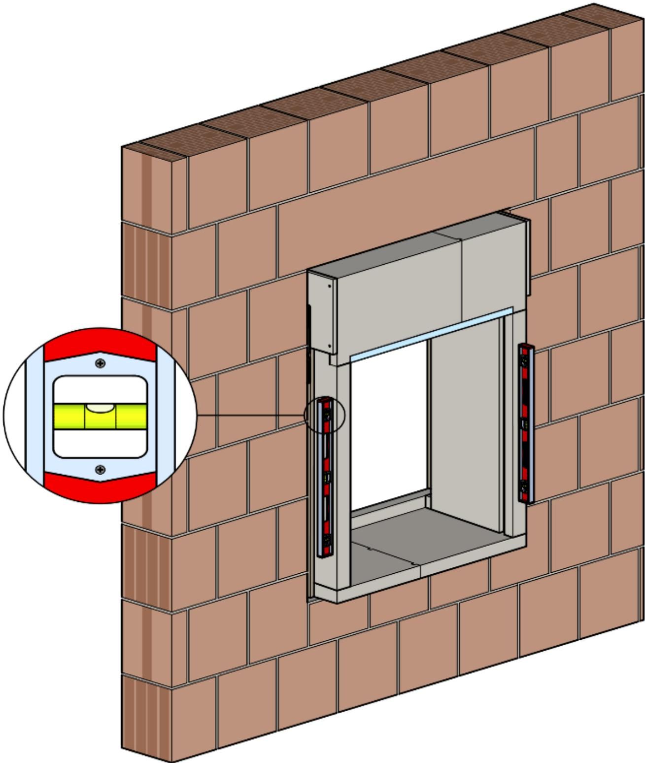
Inserire il Monoblocco nel foro finestra, prestando attenzione sia all'allineamento verticale che a quello orizzontale.
