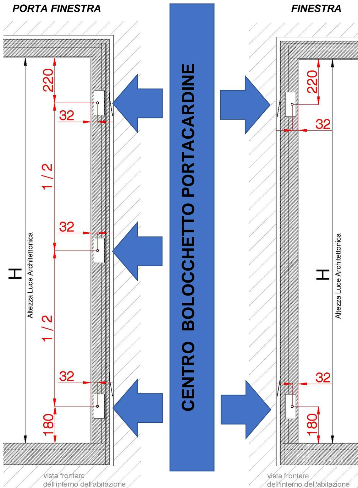
Nella versione **BLOCCHETTI TPP** è previsto, se non diversamente specificato, un pre-foro  $\varnothing$  10 mm. fornito con innestata una vite a perdere, in modo che durante le operazioni di rasatura non si copra il pre-foro. Rimuovere la vite solo a intonaco/rasatura effettuata.
